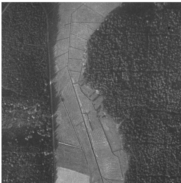
Obr. Ukázka regulace koryta pravostranného přítoku Píšťského potoka nad Bělským mlýnem na leteckém snímku z roku 1954. Současné je patrné odvodnění nivy. (zdroj: kontaminace.cenia.cz).
